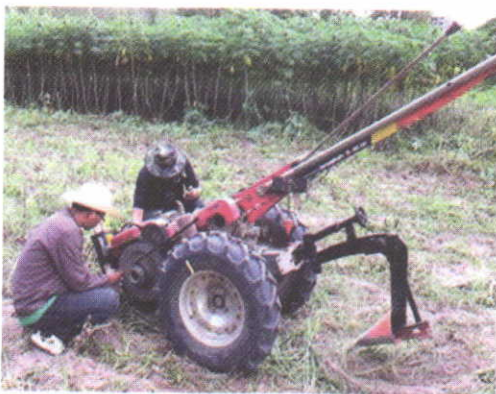
ผลขุดมันสำปะหลังแบบกรวยวงรีเอียง ต่อพ่วงกับรถไถเดินตาม
